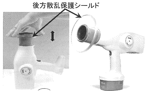
図2 後方散乱保護シールド
